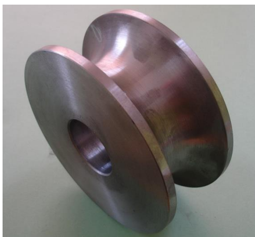
Rys. 5 Walec kształtowy stalowy do gięcia rur w giętarnie \varnothing 48 .
